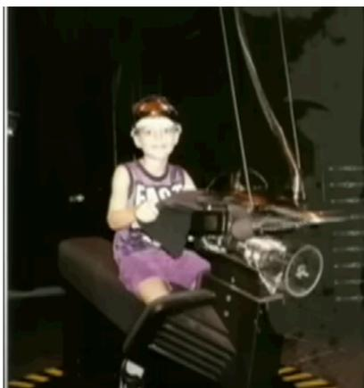
所以我参与了阿拉丁项目，其壮观程度简直令人难以置信。让我来介绍一下我的侄子克里斯托弗和那个设备。在这个项目中，参与者将坐在一个类似摩托车的装置上，体验仿佛乘着飞毯的奇妙感觉，同时，他们会佩戴一个设计巧妙的头戴式显示器。这个显示器由两个主要部分组成，它的设计非常巧妙，只有一顶小帽子会直接接触用户的头部，而所有昂贵的技术组件都安装在帽子的上方。这样的设计允许我们以极低成本大量生产帽子，因为除了帽子本身
